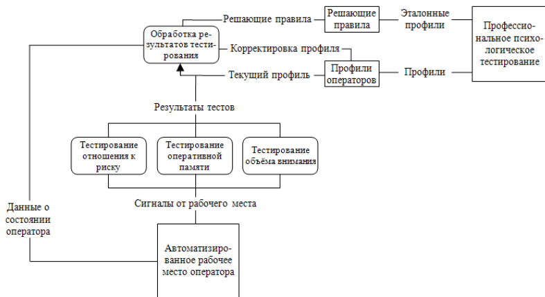
Рис. 1. Диаграмма потоков данных автоматизированной системы тестирования
