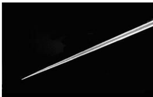
Рис. 1. Оптоволоконна наноголка, діаметр вістря 150 нм.
