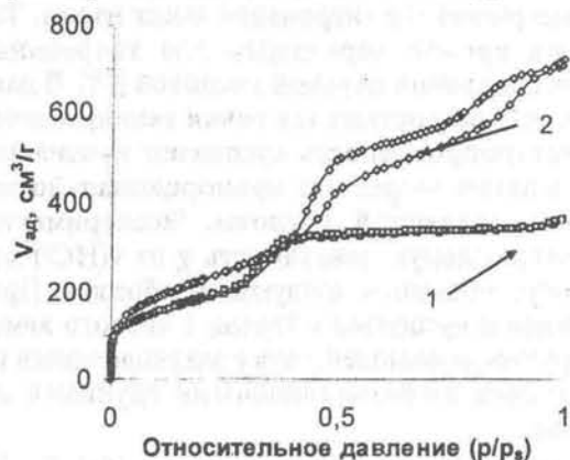
Рис. 1. Изотермы адсорбции-десорбции азота образцов 2 (1) и 5 (2).
