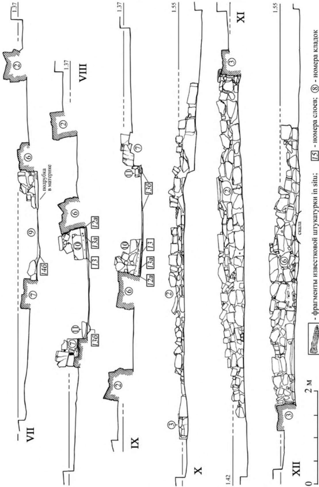
Рис. 1.3. Виды и разрезы храма (продолжение): VII – поперечный разрез нартекса и северного компартимента, вид с северо-востока; VIII – поперечный разрез по южному входу, вид с северо-востока; IX – поперечный разрез нартекса и северного компартимента, вид с юго-запада; X – северо-западный фасад; XI – продольный разрез северного компартимента, вид с юго-востока; XII – продольный разрез северного компартимента, VIII – латеральный разрез северного компартимента, вид с северо-запада.
