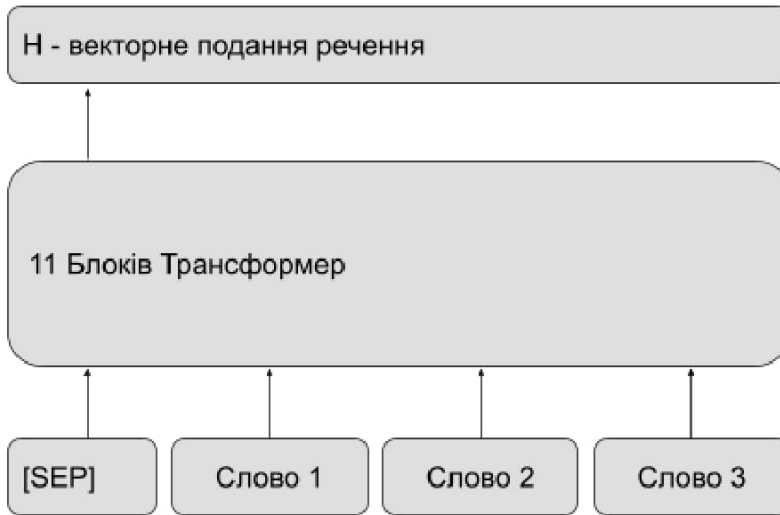
Рис 2. Схема роботи нейронної мережі BERT
