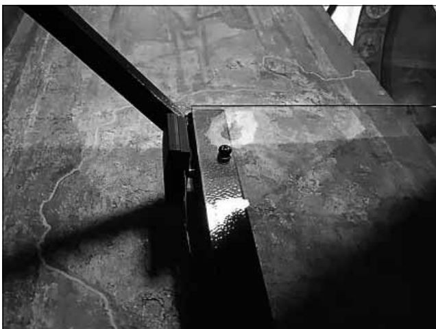
Рис. 1. Розміщення пофарбованого датчика на металевій стійці огороження
