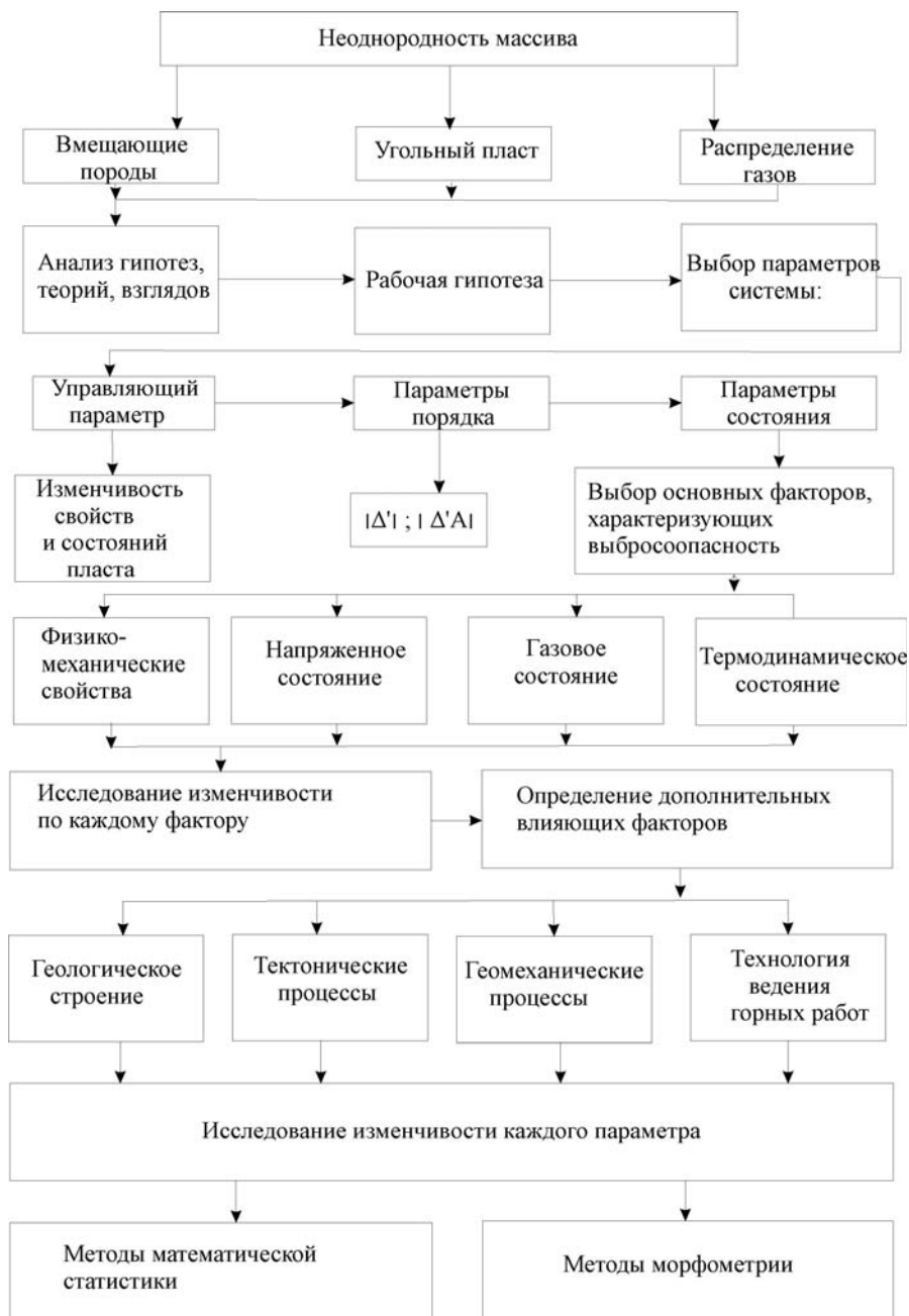
Рис. 1. Алгоритм проведения исследований по установлению особенностей формирования и проявления выбросоопасности на пологих нарушенных угольных пластах
