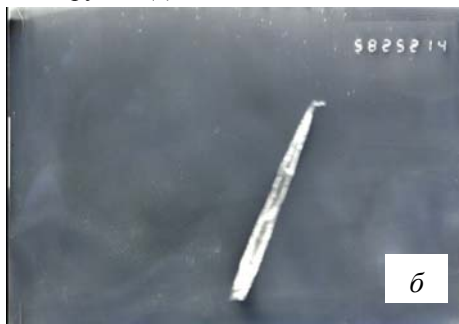
Рис. 4. ТЕМ-зображення конусоподібних нанотрбок BN з розвинутою поверхнею (а, б) та електронограма нанотрубки (в).
