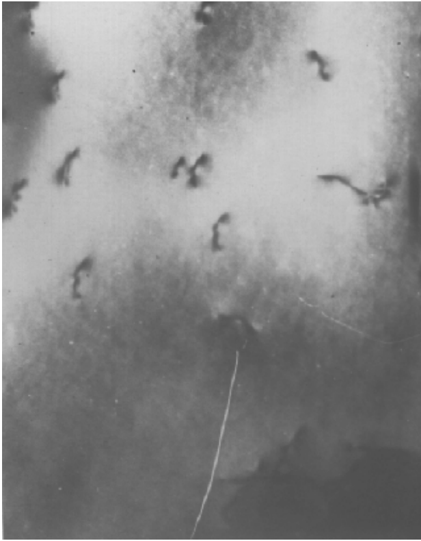
Рис. 5. Электронномикроскопическая картина термодинамически обратимого монокристалла Ta 70 Nb 30 (увеличение 98 000).
