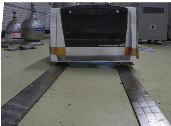
Рис. 34. Действующая модель японского транспортного средства на основе магнитной левитации с помощью ВТСП [210].
