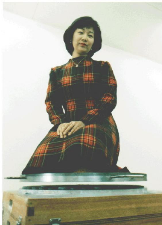
Рис. 33. Демонстрация в Японии магнитной левитации диска со встроенными постоянными магнитами над охлажденными жидким азотом элементами из ВТСП [121].
