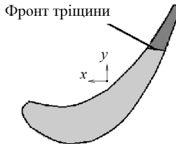
Рис. 3. Переріз пера лопатки з тріщиною.
