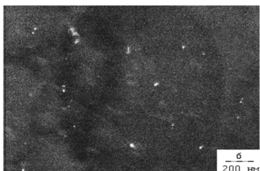
Рис. 3. Электронно-микроскопические изображения радиационно-индуцированных преципитатов в металле сварного шва реактора ВВЭР-1000 при первичном облучении (а), восстановительном отжиге (б), повторном ускоренном облучении (в)
