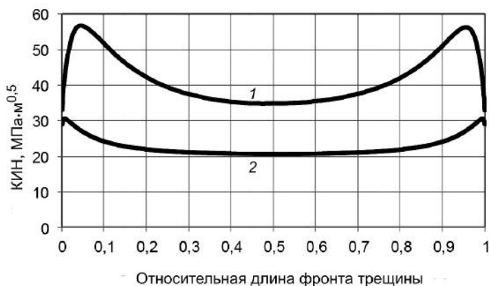
Рис. 4. Распределение КИИ вдоль фронта постулируемой трещины при нормальных условиях эксплуатации.
