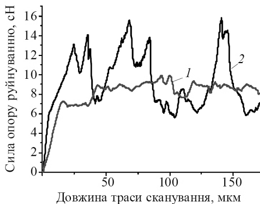
Рис. 6. Зміна сили опору руйнуванню за методом склерометрії неокисдованого (1) та окисдованого (2) сплаву ВН-10 після наводнювання.
