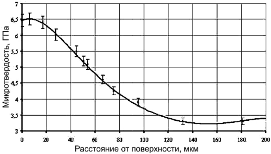
Рис. 6. Изменение микротвердости поверхностного слоя образца из сплава ВТ9 после комплексной обработки (МАО+ХТО).
