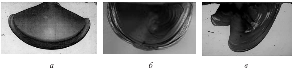
Рис. 7. Характерные шрамы сколов на кромках образцов плоского стекла: а – псевдоконическая форма; б – ногтеобразная; в – неопределенная.
