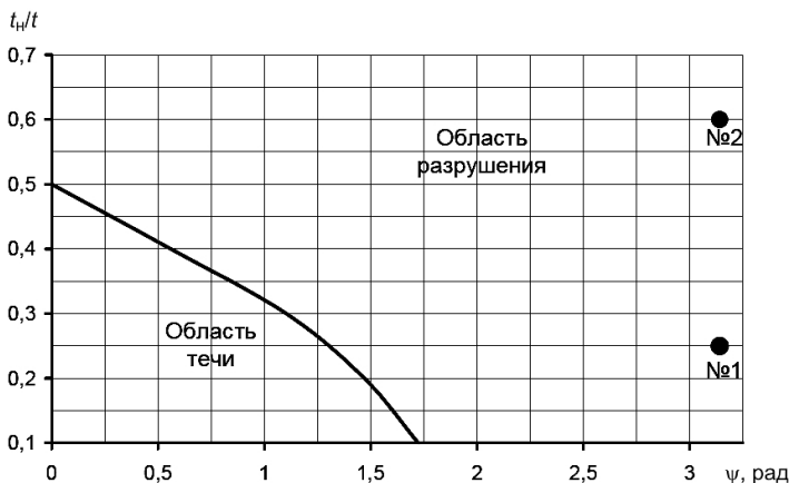
Рис. 12. Условная расчетная граница между областями течи и разрушения трубных образцов.
