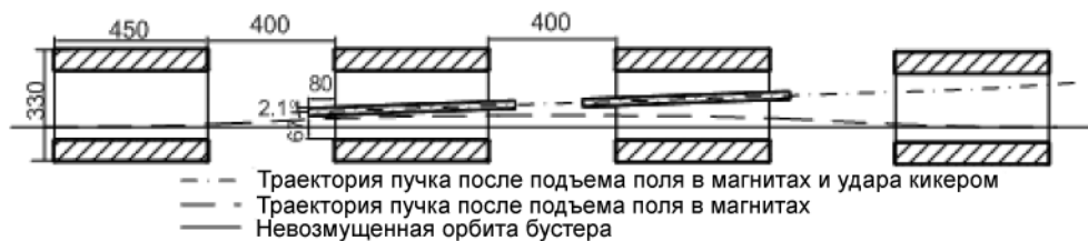
Рис.8. Байпас с магнитными экранами
