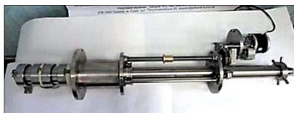
Рис. 4. Магнетронний випарувувач для нанесення покриття в каналі гарматного ствола
