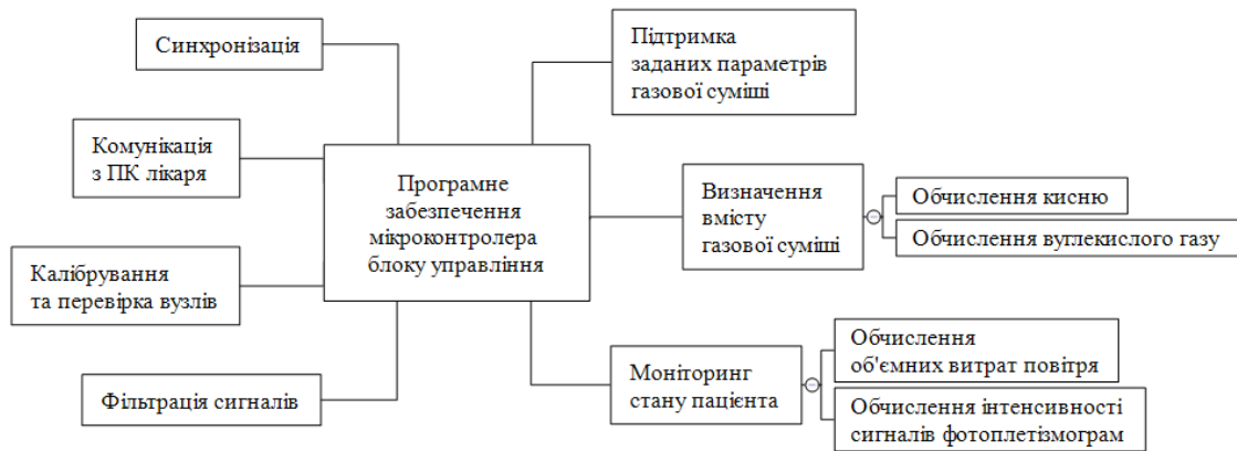
Рис. 2. Функціональна декомпозиція програмного забезпечення блоку управління
