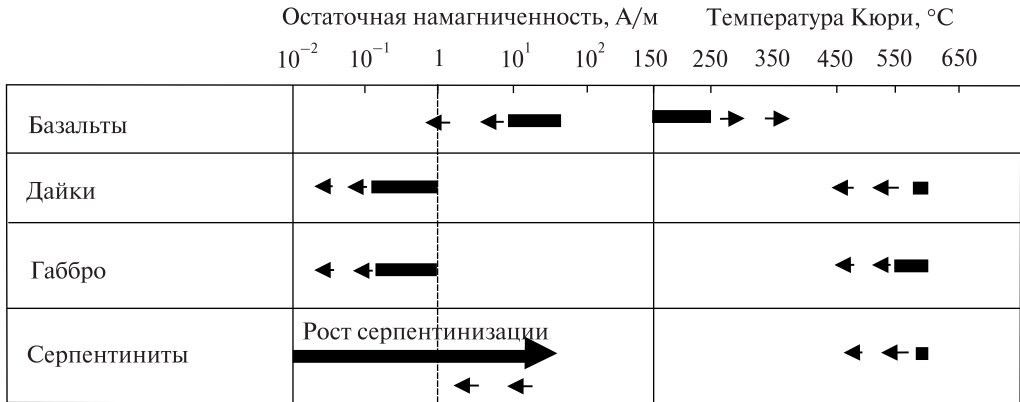
Рис. 11. Типичные значения остаточной намагниченности и температуры Кюри для образцов пород дна океанов. Жирные линии — средние значения для свежих пород. Стрелки — изменение при низкотемпературной эволюции
