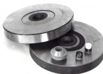
Рис. 4. Устройство высокого давления с трапецеидальными углублениями
