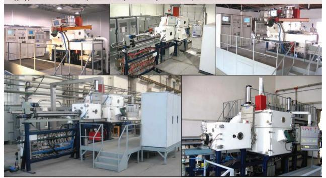
В центре разработана технология многослойного демпфирующего и эрозионностойкого градиентного наноструктурного покрытия для защиты лопаток из титановых сплавов.
