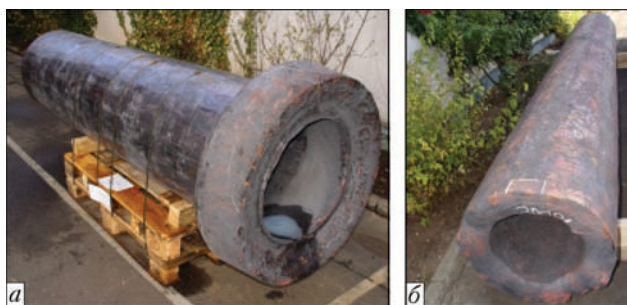
Рис. 5. Поковки для кристаллизаторов: а — изготавливаемых ковкой из слитка с прикованным фланцем (3,5 т); б — бесшовный кованый корпус (6,8 т)
