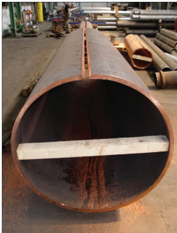
Рис. 1. Корпус кристаллизатора готовый для сварки
