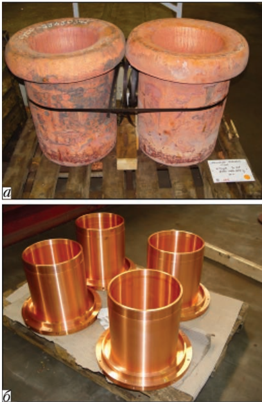
Рис. 13. Бесшовные кованные кристаллизаторы для ЭШП (а, б — см. в тексте)
