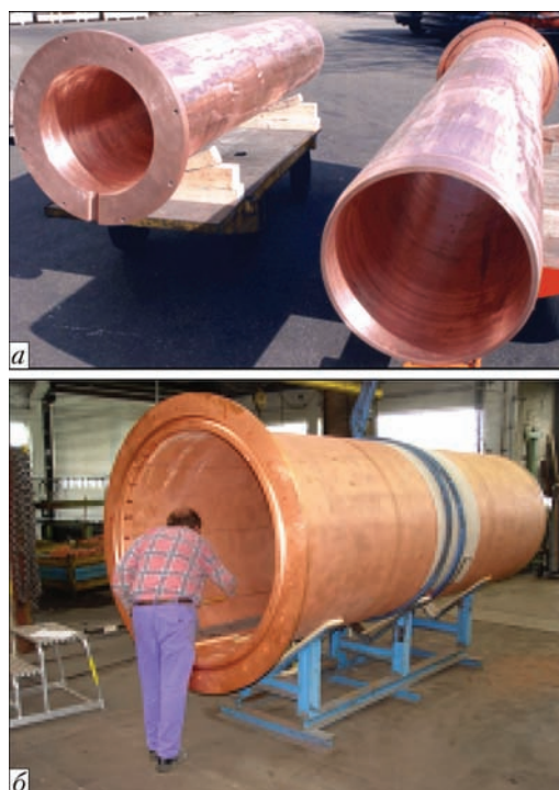
Рис. 3. Круглые кристаллизаторы, изготовленные по обычной технологии с одним продольным швом: материалы — Cu-DHP (SF-Cu) (а), Cu-HCP (SE-Cu) (б); размеры — \varnothing 536 \times 3000 мм (а), \varnothing 1200 \times 3800 мм (б); вес — 1316 кг (а), 3800 кг (б)
