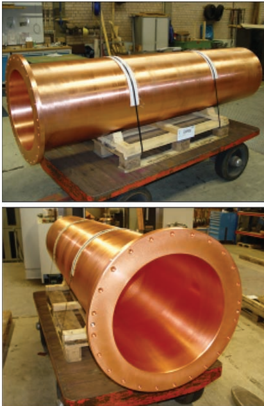
Рис. 7. Бесшовный медный кристаллизатор, изготовленный ковкой из слитка с окончательной обработкой
