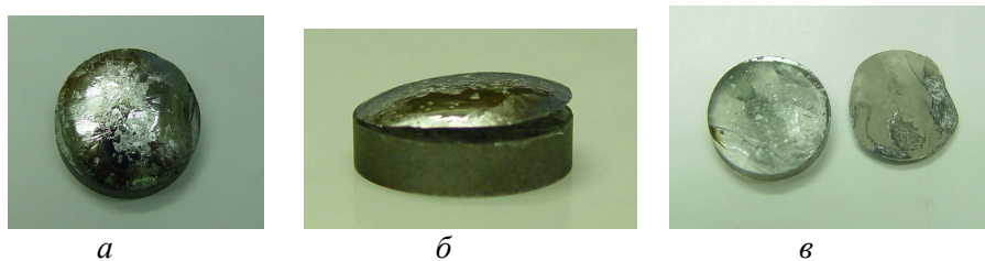
Рис. 3. Розплав, що за кристалізувався в системі кварцове скло—розплав Ni + 70% (мас.) Ti: a — погляд згори; б — погляд збоку; в — підкладка та відокремлений сплав
