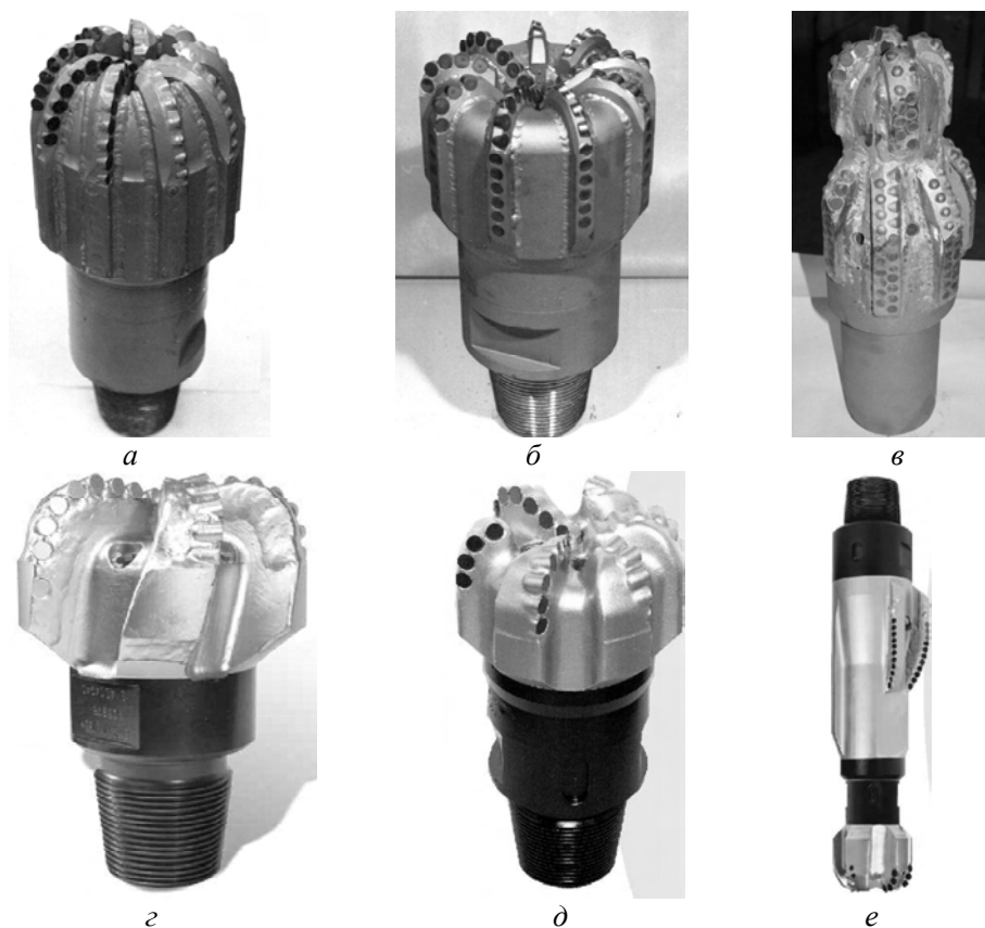
Рис. 1. Алмазные долота производства ИСМ (а–в), “Varel” (г), “Hughes Christensen” (д, е) для бурения нефтяных и скважин.
