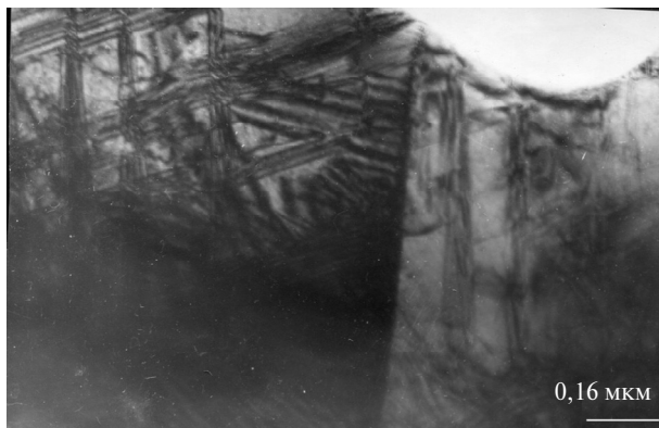
Рис. 2. Структура границы Co/Co [67].
