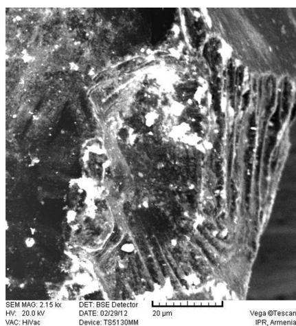
Рис. 2. Фрактограмма поверхности металлизированного зерна алмаза порошка марки HSD 90 зернистостью 500/400 мкм, \times 2150 .
