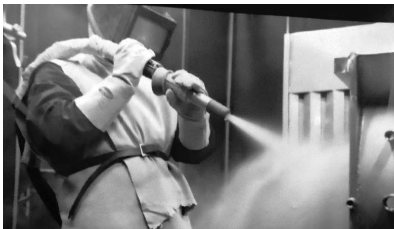
Примеры пескоструйной обработки металлоизделий в специальных камерах разной величины
