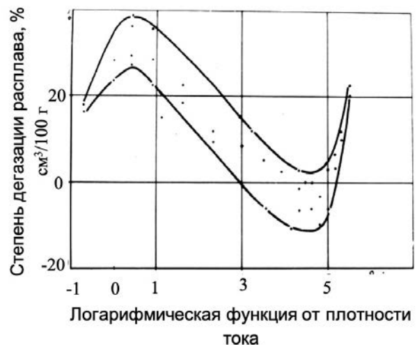
Рис. 9. Зависимость степени дегазации алюминия от плотности электрического тока при обработке потока расплава на желобе в процессе разлива в условиях промышленного производства
