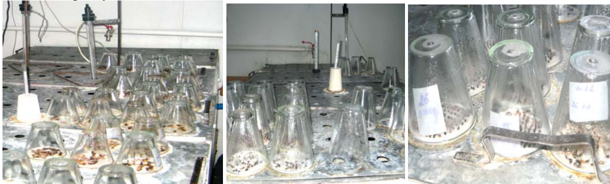
Рис. 3 – Лабораторне обладнання, за допомогою якого визначають посівну якість насіння деревних і чагарникових порід методом пророщування (зліва направо: ложе при 20 – 30°С; ложе при 20°С; маркування зразків)
