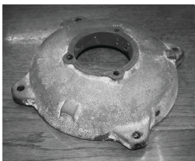
Рис. 9. Отливка «крышка», чугун СЧ 20 ГОСТ 1412-85
