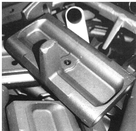
Рис. 7. Гусеничный трак (Process Inc.) и коленчатый вал для герметичного компрессора (Wagner Castings и Tecumseh Products) из ADI [12]
