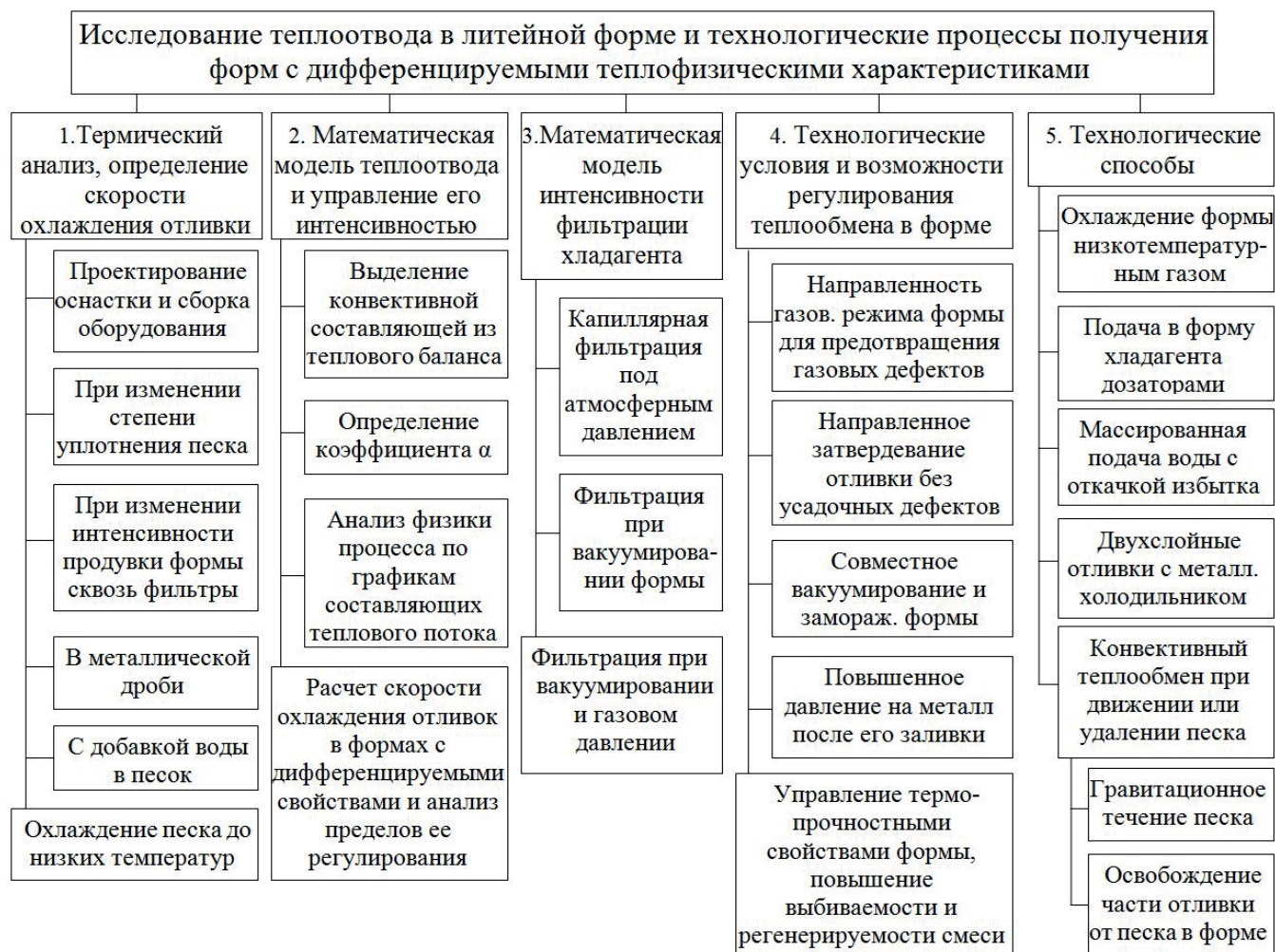
Рис. 3. Структура исследований и технологических разработок по регулированию скорости охлаждения отливки в литейной форме
