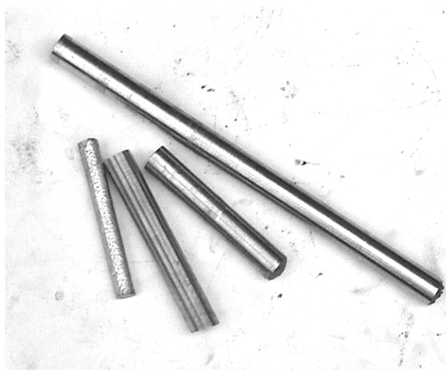
Рис. 4. Литые заготовки из сплава циркония Ø 26 мм (а) и 15 мм (б); заготовки Ø 15 мм – после механической обработки
