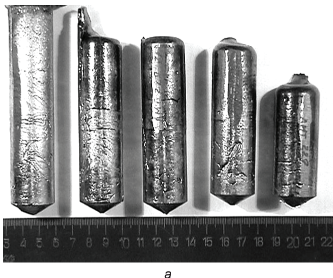
Рис. 4. Литые заготовки из сплава циркония Ø 26 мм (а) и 15 мм (б); заготовки Ø 15 мм – после механической обработки
