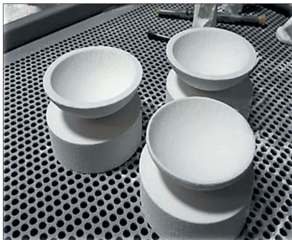
Рис. 5. Заготовки обтічників для подальшого спікання, виготовлені за допомогою 3D-друку
