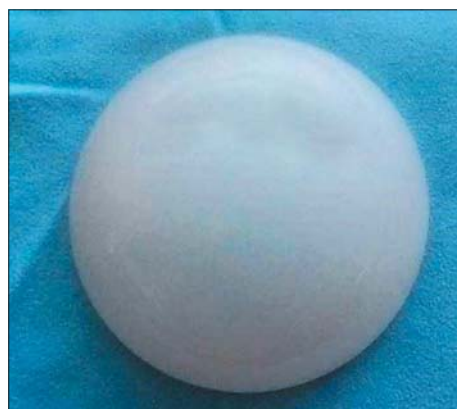
Рис. 6. Зразок ІЧ-прозорого обтічника після іскро-плазмового спікання
