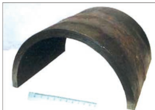
Рис. 1. Загальний вигляд зразка, вирізаного з трубопроводу риформінгу
