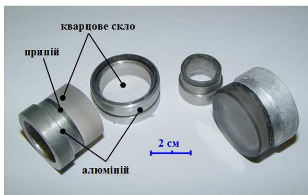
Рис. 5. Зразки макетних паяних з'єднань, виготовлених за розробленою експериментальною технологією
