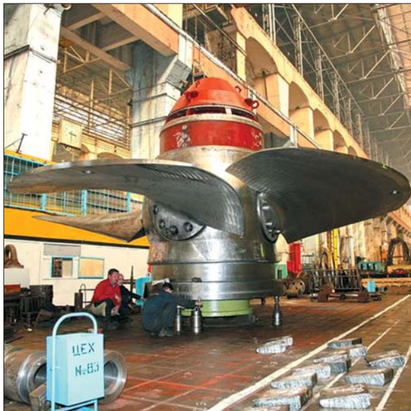
Рис. 3. Нова лопатева система робочого колеса типу ПЛ-20, розроблена в Інституті проблем машинобудування ім. А.М. Підгорного НАН України з використанням методів просторового профілювання для модернізації гідротурбін Кременчуцької ГЕС
