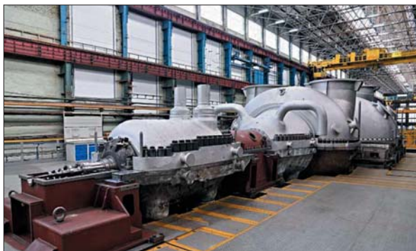
Рис. 1. Парова турбіна Т-120/130-12,8 виробництва ЗАТ «Уральський турбінний завод» з розробленою в Інституті проблем машинобудування ім. А.М. Підгорного НАН України проточною частиною циліндра середнього тиску. Турбіну встановлено на Мінській ТЕЦ-3 (Республіка Білорусь)
