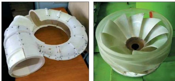
Рис. 4. Спіральна камера, виготовлена за допомогою 3D-друку, і перший варіант робочого колеса швидкохідної насос-турбіни для ГАЕС потужністю 200 МВт
