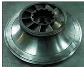
Рис. 5. Турбодетандерна установка комплексної підготовки газу і серія проточних частин турбін радіально-осьового типу, розроблених в Інституті проблем машинобудування ім. А.М. Підгорного НАН України
