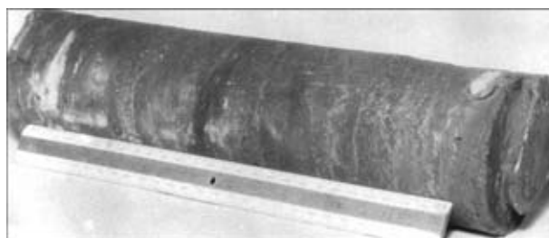
Рис. 4. Слиток хрома, полученный методом плазменно-дугового переплава
