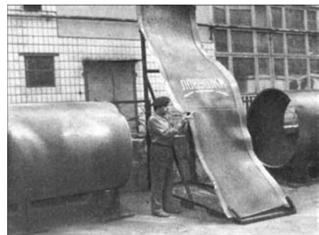
Рис. 5. Макроструктура (а) листовой стали ЗАС для ловушек — гасителей трещин, схема испытаний (б) и внешний вид ловушки-гасителя после разрушения (в): 1 — разгонная труба; 2, 3 — гасители; 4, 5 — трубы; К — кумулятивный заряд
