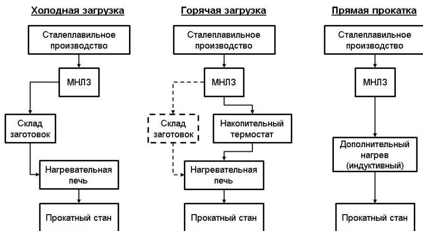
Рисунок 1 – Производственный процесс между УНРС и прокатным станом
