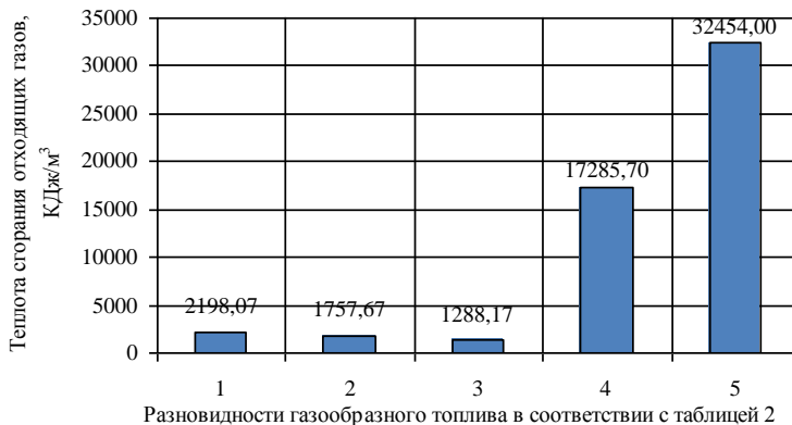
Рисунок 3. Низшая теплота сгорания различных газообразных топлив, применяемых в металлургии: цифры над столбцами – численное значение низшей теплоты сгорания, КДж/м 3
