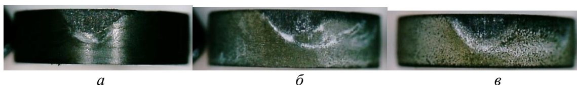
Рис. 6. Микрофотографии участка износа режущей кромки пластин композита алмаз- \text{CaMg}(\text{CO}_3)_2 : без отжига на воздухе (а); после отжига на воздухе при температуре 900°C; после отжига на воздухе при температуре 1200°C
