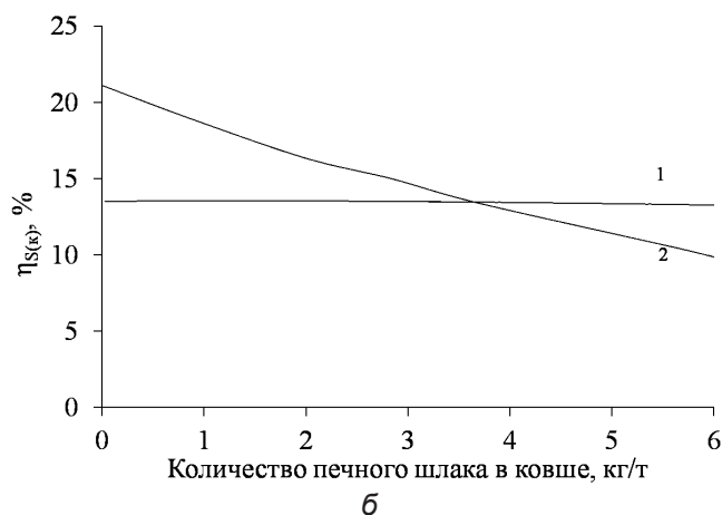
Рис. 9. Оценка конечной концентрации серы в металле (а) и степени десульфурации (б) с учетом кинетического запаздывания: кривая 1 получена с использованием выражений (7) и (8) для сульфидной емкости, оцененной по уравнению (3); 2 – по методике [26, 27] с использованием модели кинетического запаздывания, предложенной в работе [31]
