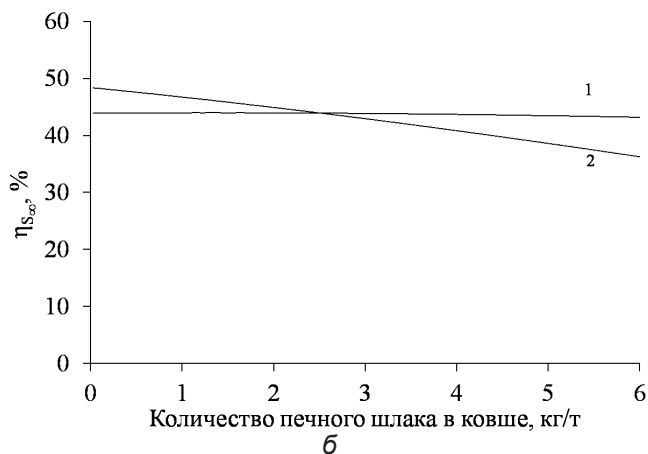
Рис. 6. Оценка равновесной концентрации серы (а) и степени десульфурации (б); расчет выполнен для сульфидной емкости, оцененной по уравнениям: 1 – (6), 2 – концентрация серы определена из данных рис. 1
