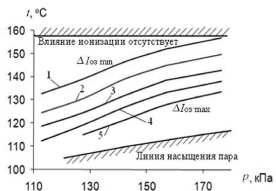
Рис. 9. Эффективность ионизации пара в зависимости от изменения давления и температуры: 1 – \Delta I_{oz} = 50 мкА; 2 – \Delta I_{oz} = 100 мкА; 3 – \Delta I_{oz} = 150 мкА; 4 – \Delta I_{oz} = 200 мкА; 5 – \Delta I_{oz} = 250 мкА
