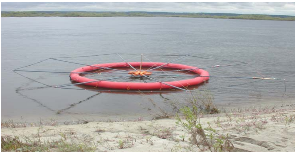
Рис. 3. Соосная генераторно-измерительная установка электромагнитного сканирования
