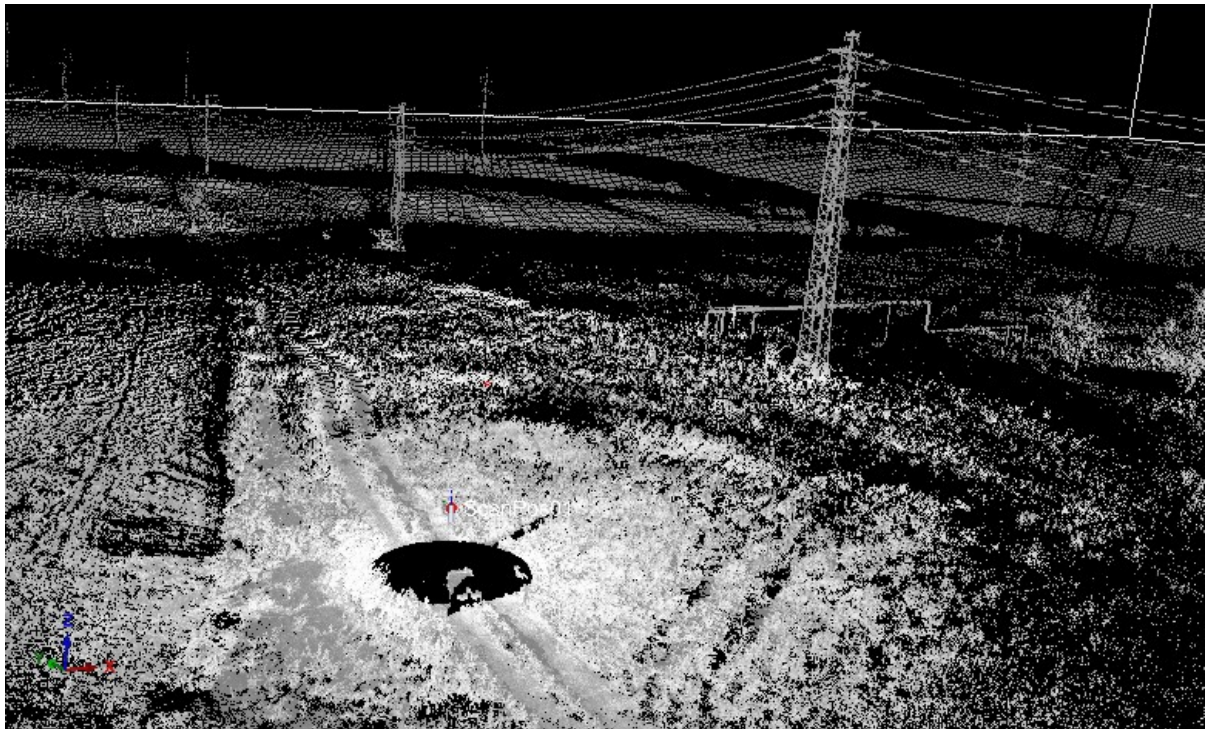
Рис. 2. Пример «сырых» данных, полученных в результате предварительного разреженного сканирования
