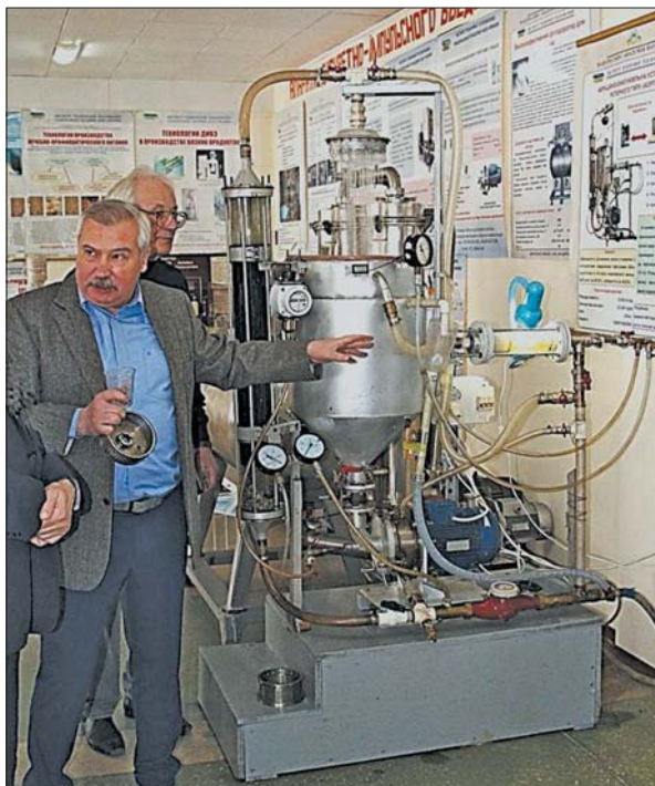
Установка для очищення води, створена в Інституті технічної теплофізики НАН України
