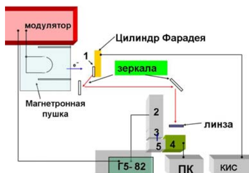
Рис.1. Структурная схема автоматизированной системы оптического отображения профиля пучка
